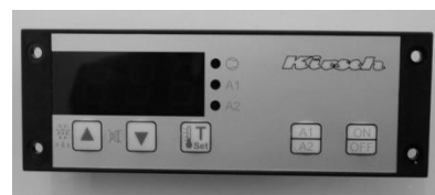
Frontansicht digitale Temperaturanzeige
